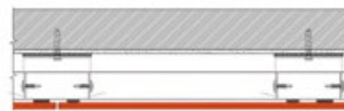
6. Стальной каркас из потолочных профилей Гургос-Ультра или Кнауф с заполнением из плит или матов.
